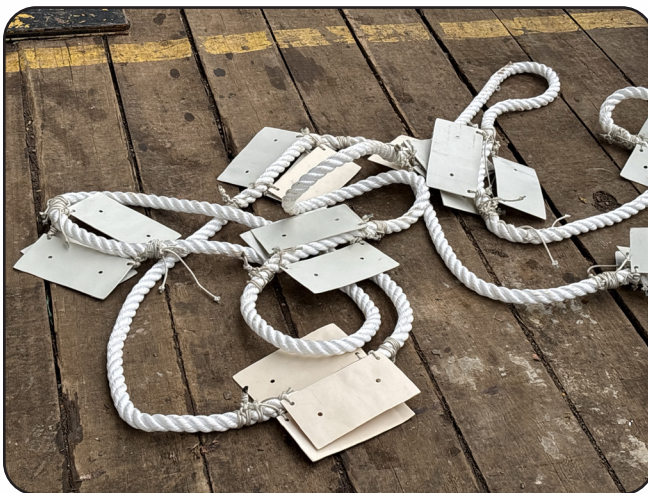
Instalação de placas de incrustação
