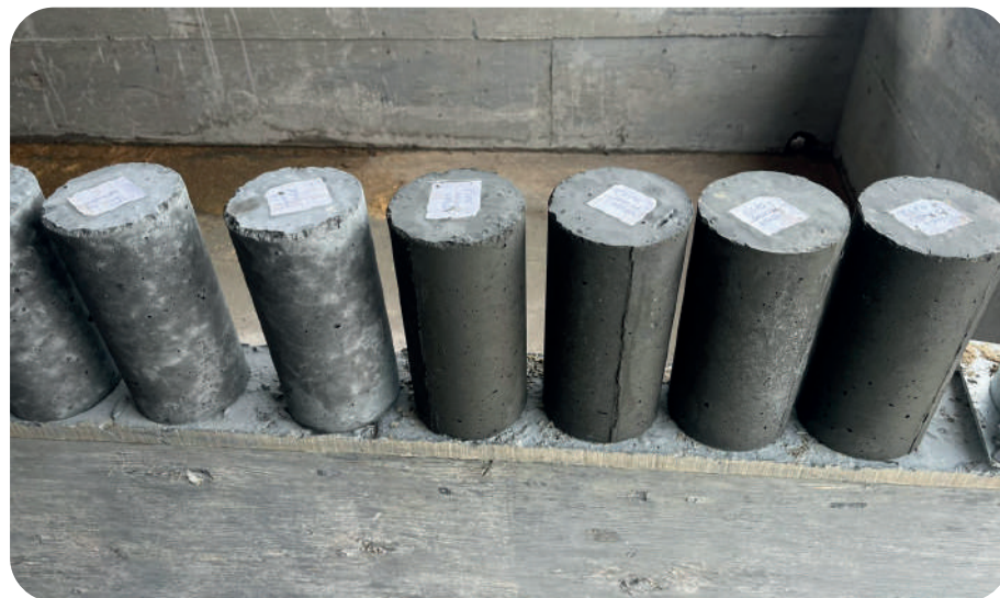
Amostras de testagem de concreto feitos na Usina de Concreto. Imagem: CSPG.
