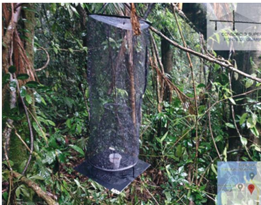
Método Armadilha Van Someren Rydon. Imagem: CSPG
